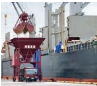
本船より撤貨物をホッパー取りし、トラックで直送 Cargo unloaded from vessels is transferred directly to trucks via a hopper system.
