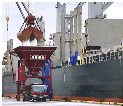
本船より搬貨物をホッパー取りし、トラックで直送 Hopper collecting/unloading goods from a ship and sending it directly by truck.
