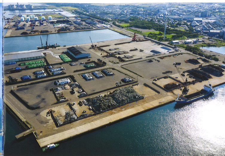
中央埠頭(中央岸壁) 1・2号岸壁があり、1号岸壁の係留能力はD/W5,000t、2号岸壁はD/W15,000tの係留能力です。主にスクラップ船の荷役に使用されています。 Center pier (Center berth) There are 2 berths. No.1 berth has a mooring ability of D/W 5,000t and No.2 berth has a mooring ability of D/W 15,000t. Those berths are used for handling cargo of scrap mainly.
