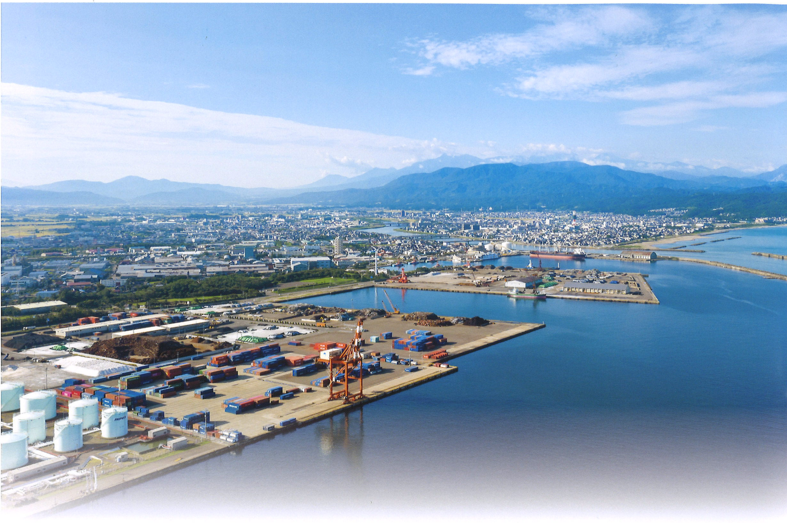
中央埠頭(中央岸壁) 1・2号岸壁があり、1号岸壁の係留能力はD/W5,000t、2号岸壁はD/W15,000tの係留能力です。主にスクラップ船の荷役に使用されています。 Center pier (Center berth) There are 2 berths. No.1 berth has a mooring ability of D/W 5,000t and No.2 berth has a mooring ability of D/W 15,000t. Those berths are used for handling cargo of scrap mainly.
